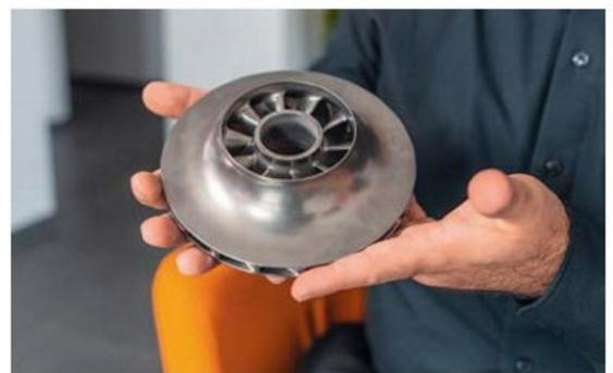
Die Abbildung zeigt einen mit CMF-Technologie hergestellten Impeller.
