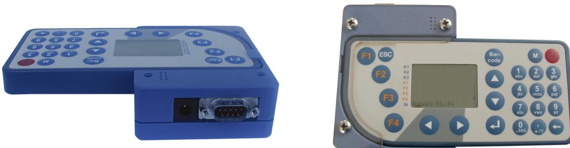
Normalerweise kann der Scanner direkt über den Com-Port angeschlossen werden. Viele PCs / Notebooks verfügen jedoch nicht mehr über einen COM-Anschluß. Sollten Sie über keinen Com-Port verfügen, so schließen Sie den Scanner bitte mit dem mitgeliefertem USB-Comport-Kabel an. Hierzu verlängern Sie das Com-Port Kabel um das USB-Kabel. Schließen Sie das Stromkabel an. Stecken Sie den Scanner in die Dockingstation.
